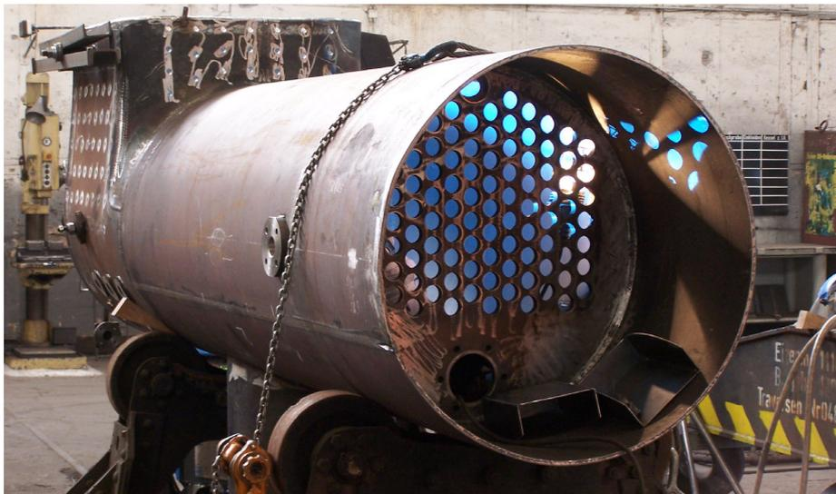
„Der Kessel besteht aus den Hauptteilen: Hinterkessel, Langkessel u. Rauchkammer.
